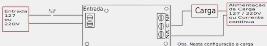
Obs. Nesta configuração a carga será ligada ao energizar a entrada. Se quisermos manter a carga ligada e desligar ao desenergizar a entrada usamos os contatos "C" e "NF"
